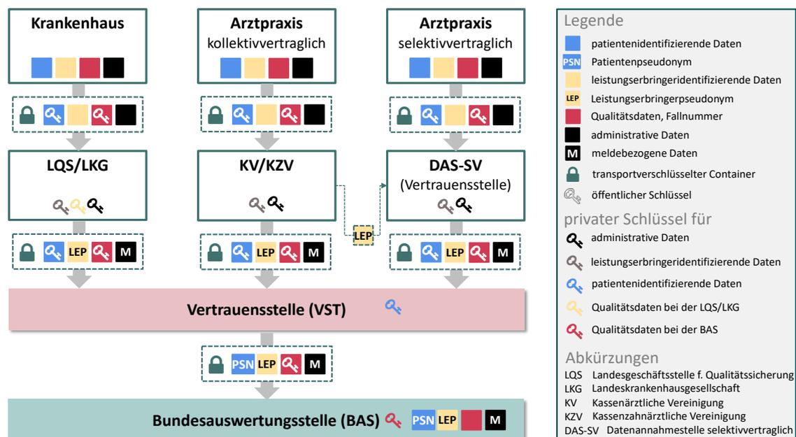
Abbildung 1: Serielles Datenflussmodell für die sektorenübergreifende Qualitätssicherung
