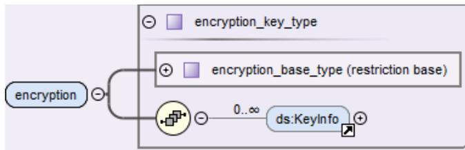
Abbildung 19: Aufbau und Attribute des Elements `encryption`(Krankenhaus)
