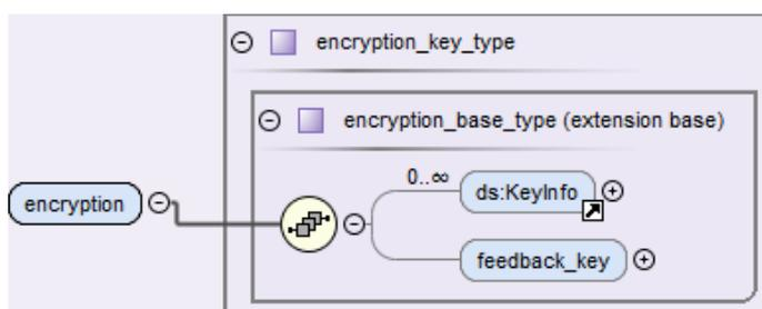
Abbildung 20: Aufbau und Attribute des Elements `encryption`(AP-selektiv/-kollektiv)
