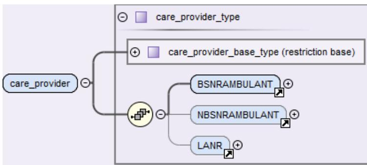
Abbildung 24: Aufbau des Elements care\_provider – kollektiv-, selektivvertraglich
