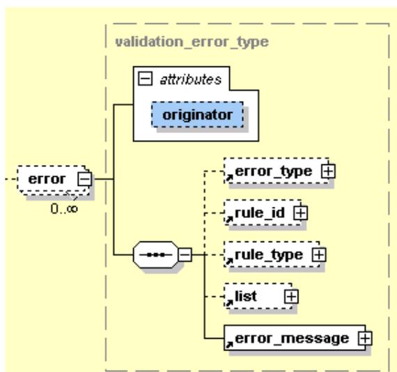
Abbildung 7: Attribut „originator“ im Prüfungs- und Fehlerprotokoll
