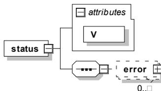
Abbildung 40: Aufbau und Kind-Elemente des Elements `status`
