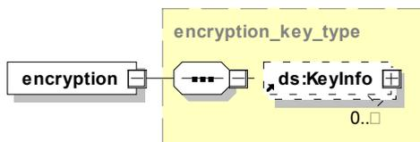
Abbildung 42: Aufbau und Attribute des Elements encryption(Krankenhaus)
