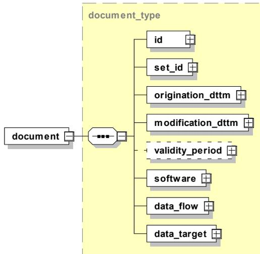
Abbildung 32: Aufbau des Elements document
