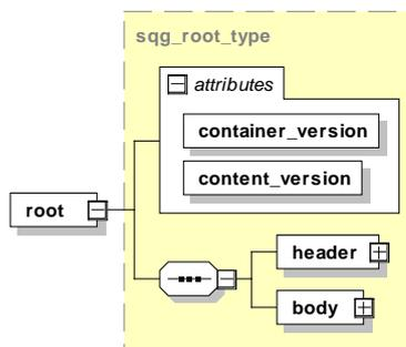
Abbildung 29: Root-Element und Kind-Elemente header und body
