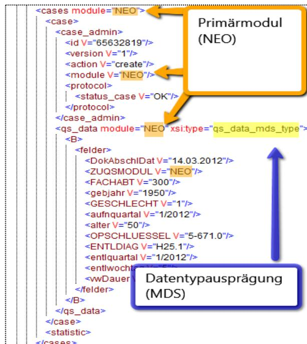
Abbildung 57: Integration des MDS in das Primärmodul
