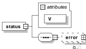
Abbildung 39: Aufbau und Kind-Elemente des Elements `status`
